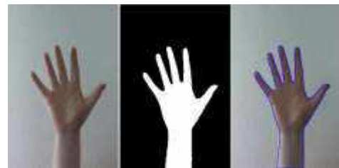
Hình 2. Thuật toán xác định vùng quan tâm, mặt nạ nhị phân và đường viền của các cử chỉ tay. Thuật toán được lập trình và thử nghiệm sử dụng OpenCV
