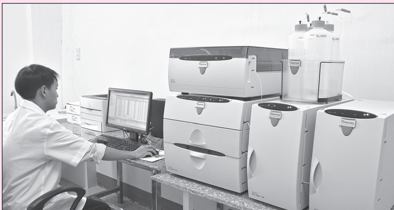
Hệ thống máy sắc ký ion, phân tích xác định được hàm lượng kim loại, các hợp chất khác trong nước, trong đất, trong thực phẩm...
